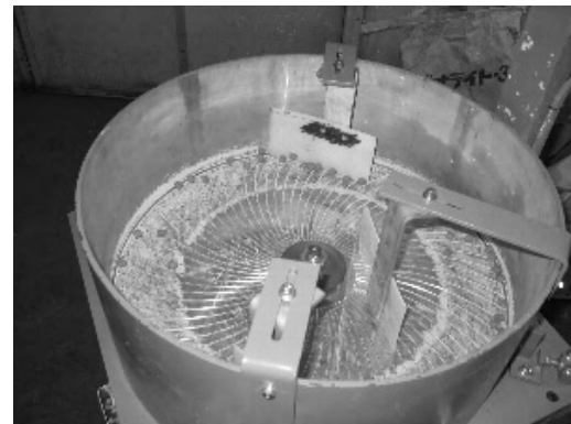
図6 マルメライザーによる球状成形
