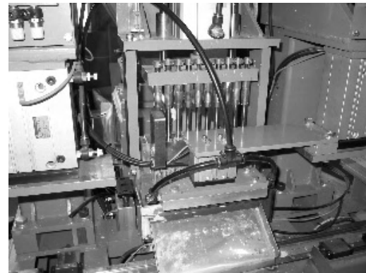
図5 押出成形による円柱状濾剤の製造機
